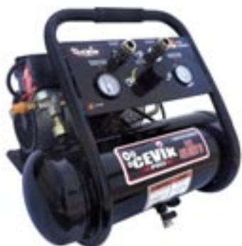
Cód. 391195 COMPRESOR PRO SILENT6 CEVIK 1 HP. 6 l. 110 l/min. 8 Bar. Sin aceite. Silencioso 62 db (A). Doble salida de aire. Ideal para trabajos de soplado, hinchado y para clavadoras-grapadoras. 140,45€ + IVA 169,95€
